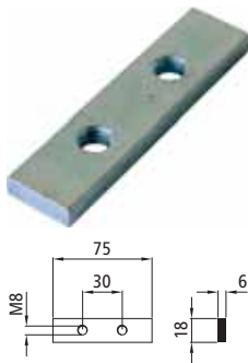
Gewindeplatte Stahl verzinkt, Gewicht 0,06 kg. 105111953
