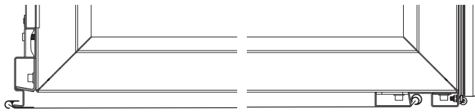
Abbildung oben: Planen-Spannhaken 670044641 und Planen-Spannrohr 670900303 positioniert in den Eckrungen
