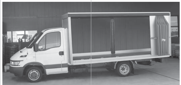
Abbildung: Fertig montierter Bausatz mit sichtbaren Zusatzoptionen Plane, Mittel­runge und Boden-Auf­steck­klatten
