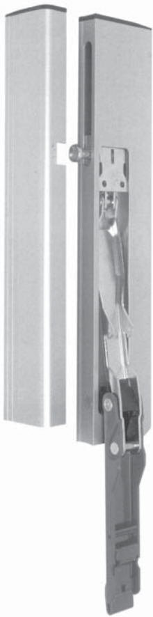
Abbildung: Beim Öffnen klappt der Handhebel vollständig ab und legt sich an der Bordwand an. Die Abbildung zeigt eine linke Ausführung.
