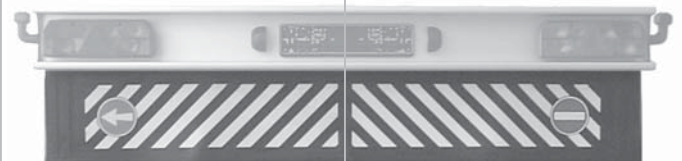
Abbildung: Heckschürze 350381278 montiert an Aluminium-Unterfahrschutz mit Lichtanlage.
