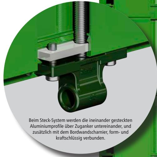
Beim Steck-System werden die ineinander gesteckten Aluminiumprofile über Zuganker untereinander, und zusätzlich mit dem Bordwandscharnier, form- und kraftschlüssig verbunden.
