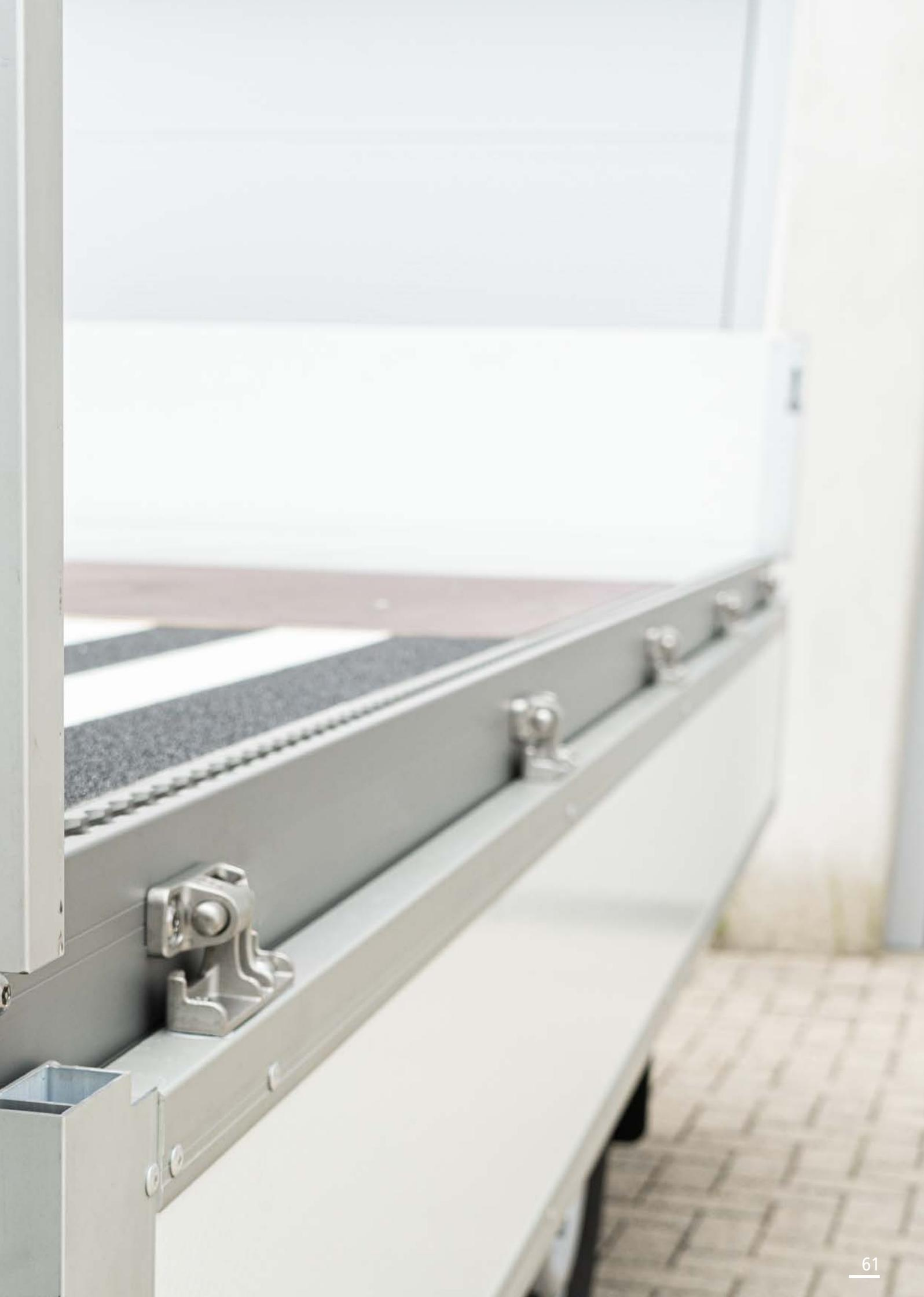
Profil **641131**: Mit Nut zum Einschieben der 30 mm hohen Bodenprofile (Pos. 1).
