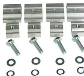
Das Gewindestück **641120** in seinen verschiedenen Varianten wird in Kombination mit der Klemmpratze **605645021** als Verbindungselement zwischen Querträgerprofil **641124** und den verschiedenen Aluminium-Hilfsrahmen oder -Bodenrahmenprofilen bei unseren Cargotrail ASP1-Bausätzen eingesetzt.
