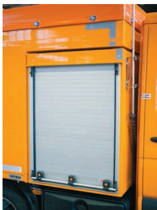
Zabezpieczenie opuszczanymi roletami.
