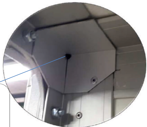
5 000 231 - Pokrycie zabezpieczające przykleić lub przynitować zarówno z przodu jak i z tyłu
