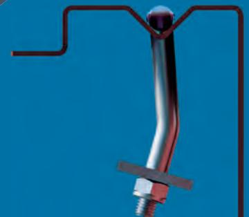
Die Zurropunkte auf der Oberseite des abgebildeten SSPL-Pritschenaufbaus stehen wie in der Norm gefordert in Ruhelage nicht über die Horizontalebene der Ladefläche nach oben hinaus.
