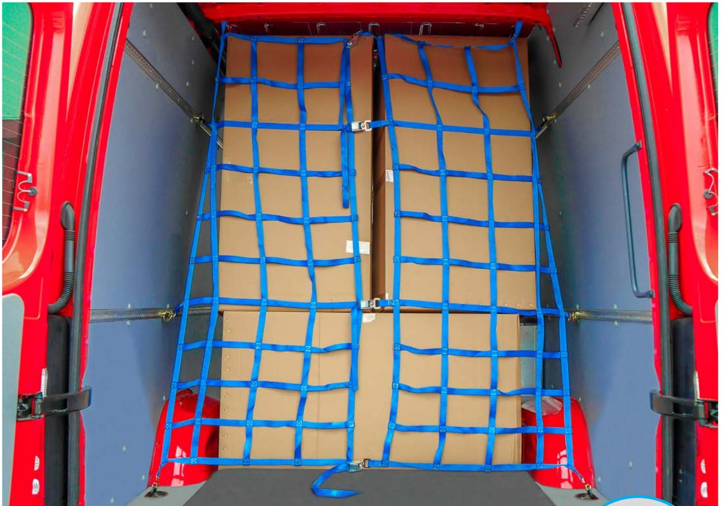
Polyestergewebe 25 mm blau, Maschenweite 175 × 175 mm. Label mit Schutzhülle, ausgestattet mit S-Haken 2501 PVC-beschichtet und Flachhaken-Sicherung 2504 für Stäbchen ø 8 mm. Zusätzlich mit 2 Adaptergurten 1000 mm, ausgestattet mit S-Haken 2501 PVC-beschichtet und Klemmschloss K25G.
